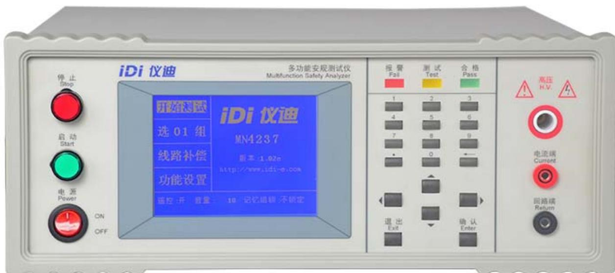
MN423XK 系列安规综合测试仪具有交流耐压、直流耐压、绝缘和接地功能联合测试，不同型号测试项目数量不同，4 项测试最快 2.5 秒完成，PID 调节 0.2 秒稳定升压升流，大尺寸 LCD 显示，高精度，高效率。
