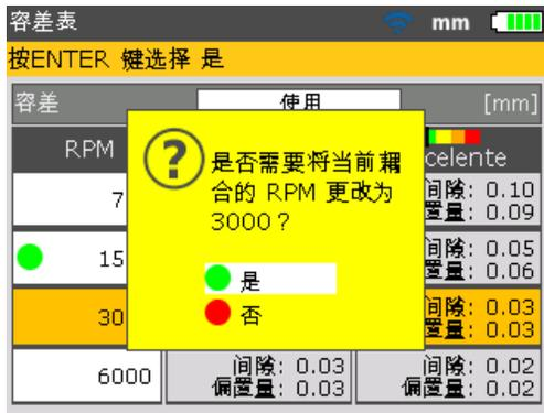
使用 / 选中“是”，然后按下 确认选择。新的 RPM 值将覆盖设置期间所输入的值。此时联轴器容差将以接受的 RPM 值为基础。
