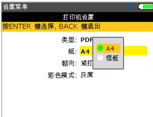
打印机设置“朝向”用于更改纸张朝向。选中“朝向”，按下 **ENTER**，然后使用 **▲** / **▼** 将纸张朝向更改为“横打”实现垂直分布或“竖打”实现水平分布。按下 **ENTER** 确认选择。
