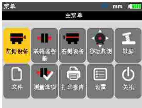
使用导航键选中“左侧机器”或“右侧机器”图标。同时按下 **ENTER**，此时将显示可编辑的机器属性。
