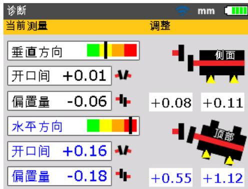
联轴器诊断形式为垂直和水平方向的开口间和偏置量值。真正的开口间为在输入的直径下，从上到下（垂直）或从左到右（水平）的开口间差异。偏置量为联轴器投射平面上两个中心线之间的距离。
