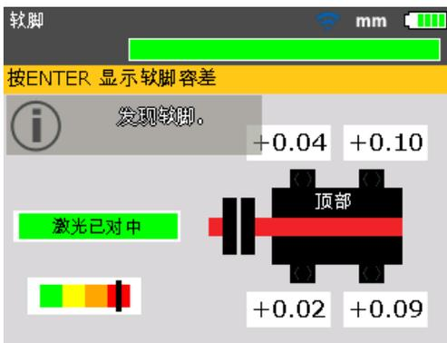
彩色编码容差条上的标记指示所测量的软脚的容差值。
