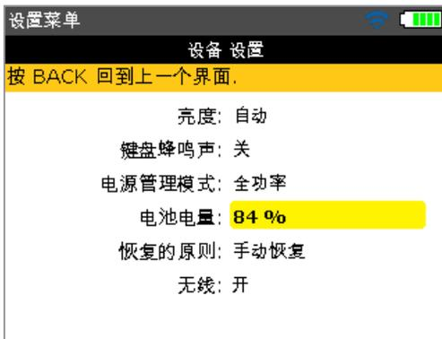
电池容量显示于电池电量条旁边。该值对应于显示屏右上角的电池图标所指示的充电电量，并在每个屏幕中显示。
