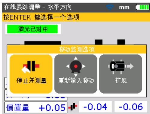
如果在拧紧过程中机器移动，应先修正软脚，并检查地脚螺栓是否翘起，垫片是否变形，然后重新对中。
