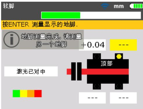
所计算的地脚移动范围显示在屏幕上。重新拧紧螺栓。下一个地脚自动选中，也可使用导航键选择任何一个所需的地脚。
