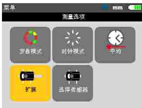
3. 使用导航键选中“扩展”图标，然后按下 **ENTER** 确认选择。程序中测测量，切换至光束调整屏幕。当前光束位置被自动记录并作为扩展测量范围的起点。
