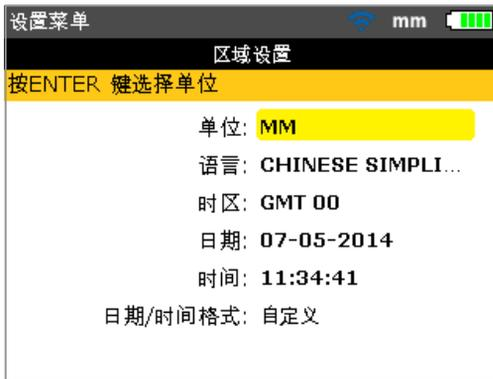
使用 **▲**/**▼** 选中“单位”，按下 **ENTER** 确认选择，此时将显示可用的测量单位。包括美帝国主义的惯用单位 (inch/mils)，英制单位 (inch/thou) 和 SI 单位 (mm)。
