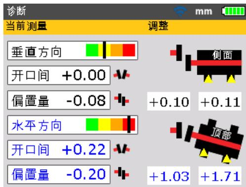
联轴器和地脚结果可在垂直和水平平面上显示。联轴器结果以开口间和偏置量形式给出。固定机器位于观测器左侧时，如果从观测器顶部或远侧打开时，开口间为正。如果右侧半联轴器高于或远离观测器，则偏置量为正。
