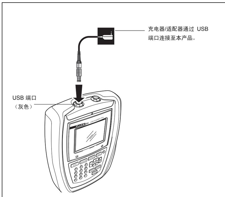
图 4-2. 对不可拆卸充电电池进行充电
