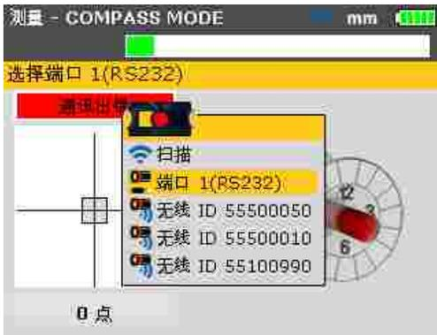
在弹出的选择窗口中，使用 **↑** / **↓** 并选中“端口 1 (RS232)”。按下 **ENTER** 确认选择。此时串行端口开始初始化。
