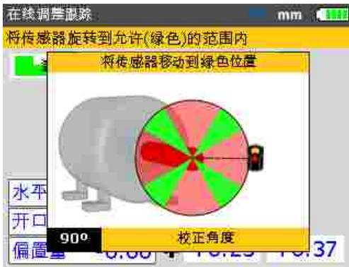
如果激光束已对中，将轴旋转至对应四个绿色区域的任何一个角位置，此时将弹出移动方向对话框窗口。
