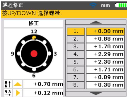
垫片修正编号应对应螺栓位置。与当前选中的垫片修正计算值相对应的螺栓位置带有编号并以橙色点高亮显示。
