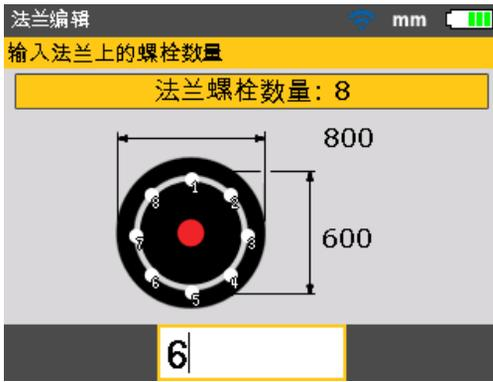
“法兰螺栓数量:”按钮被选中时，使用数据输入键直接编辑值，然后按下 **ENTER** 或 **BACK** 确认值。
