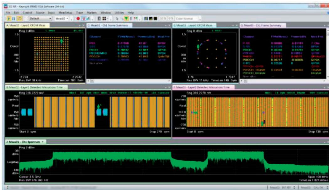
图 2：5G NR 波形生成和分析测试台解决方案，用于创建 5G 和 4G LTE 共存场景并进行设备确认测试
