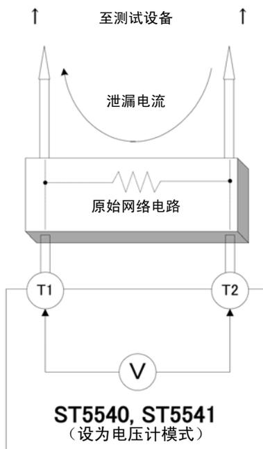
本仪器通常以安培计的形式进行操作，但也可在模式设置画面中选择电压计功能。将本仪器用作电压计时，如果网络 A ~ G 不符合所需的网络配置，则可连接到原始网络上。本仪器也可以用作一般的高频电压计。
