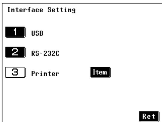
将 9442 打印机选购件连接到主机后面板上的 RS-232C 端口上，可以打印数据。连接打印机之后，不能使用 RS-232C 或 USB 与 PC 进行通讯。
