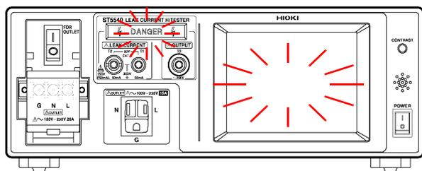
**DANGER** 指示灯和 LCD 背光交替闪烁。确认所有指示灯的状态。
