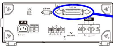
1. 请将 EXT I/O 电缆连接器连接到主机的 EXT I/O 端子上。
