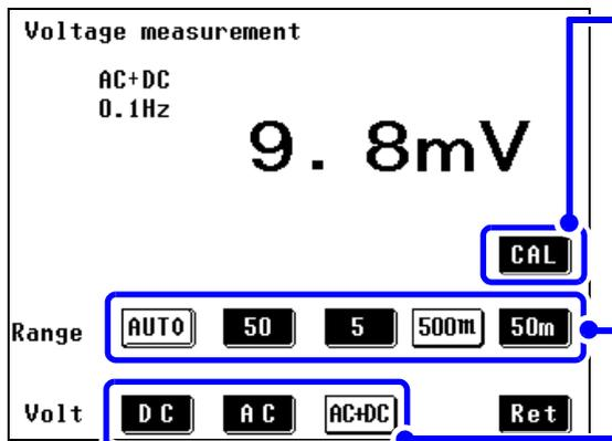
选择 **Voltmeter** 显示电压计测量画面。电压测量画面开始电压计测量。可在测量期间变更测量条件。
