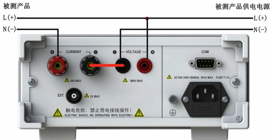
图 4-5 外部接线示意图
