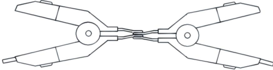
图 3-6 正确的测试端短路方法
