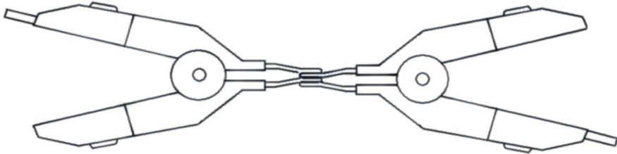
图 3-7 错误的测试端短路方法
