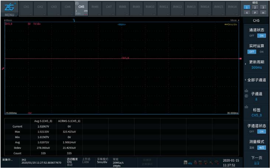
图 4.9 直流电压测量
