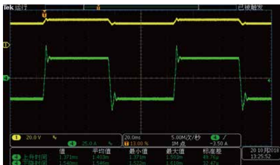
启动浪涌电流超电流量程,高速建立电压
