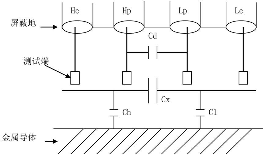
图 5-1 杂散电容的影响示意图
