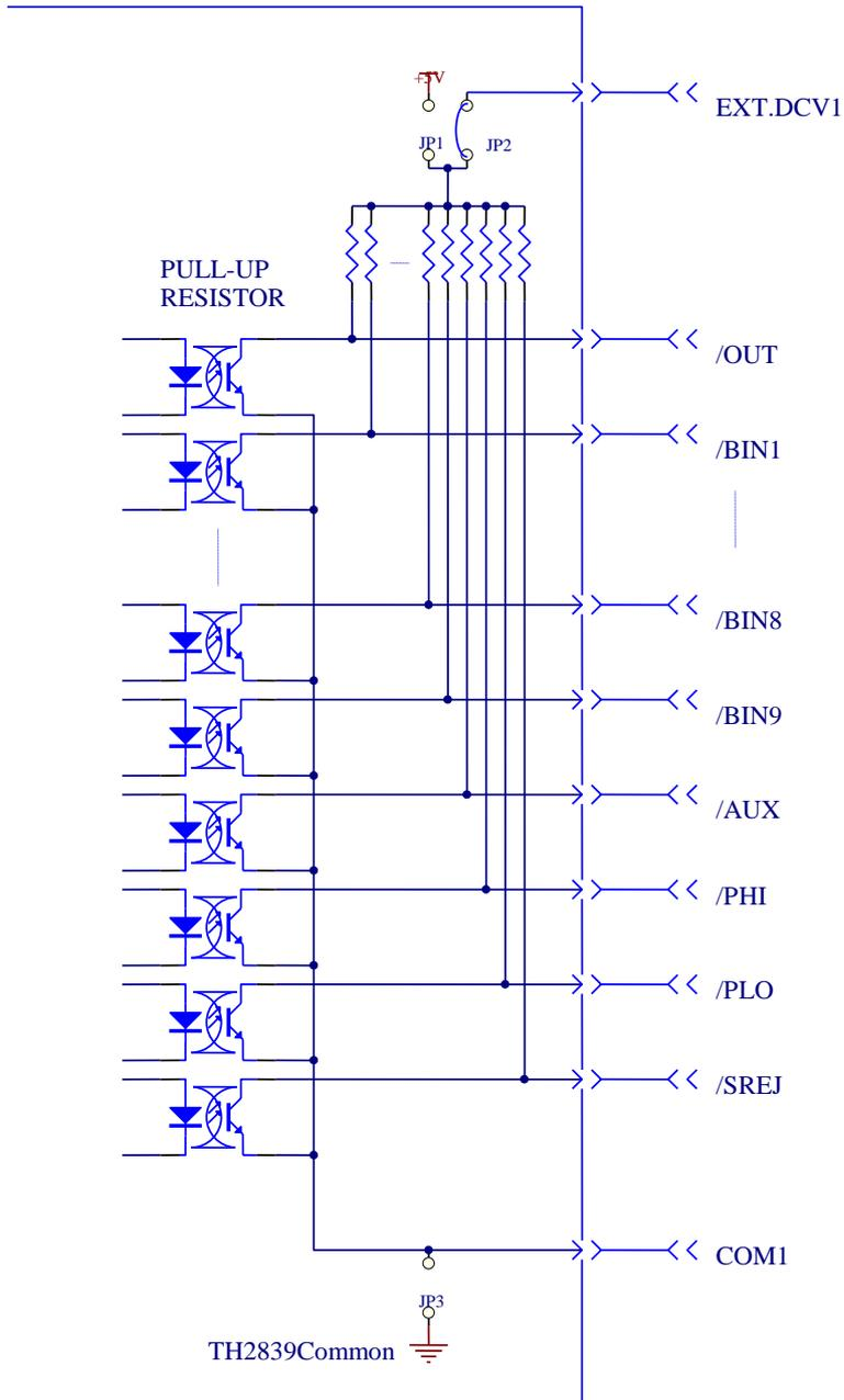
控制信号输出电路
