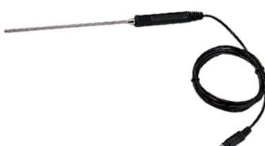
GOM-804/805 具有温度测试及温度补偿功能，使用时需要选配 PT-100 选件，把 PT-100 接到 GOM-804/805 即可实现温度测量，温度测量范围为 -50°C~399.9°C，测量分辨率可达 0.1°C。同样选配 PT-100 后还可以实现温度补偿测量功能，快速，准确的完成测量任务。
