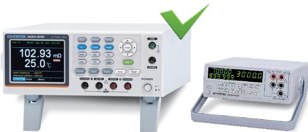
GOM-804/805无论是在基本的功能、规格上，都可完全取代现有机型~GOM-802；因此，所有GOM-802能提供的，都可以在GOM-804/805上找到完全对应的功能，包括可涵盖既有范围的电阻测量、1A测试电流(最大)、四线制测量方式、以温度测棒(选购配件PT-100)进行温度测量或温度补偿测量...等；甚至在程控所需的指令，也能全数兼容。简言之，全新的GOM-804/805，除了能提供更佳的显示接口、更快速的测量速度(可达每秒60个读值)，甚至标配通讯接口(RS-232C/USB Device)，帮助使用者精准、快速地完成测量工作；同时，在机型替换上也不会造成任何的困扰和麻烦。
