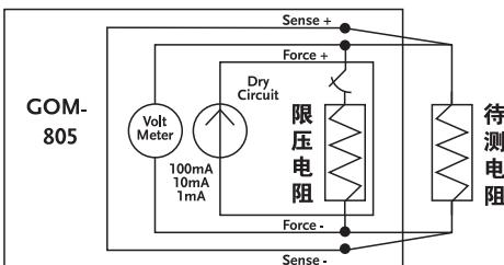
干电路 (Dry circuit)，就是将测试电压和电流限制到不能引起接触点产生物理或电学变化的电路，常见的应用是接触阻抗的测量。依据 MIL-STD-1344 的方法 3002-1~低信号准位接触电阻，测试时必须限制最大开路电压在 20mV( 含 ) 以下，而短路电流则为 100mA 或更低的情况，以避免组件两端的电压过高，破坏了接触点表面的氧化层或薄膜，进而破坏测量的有效性。GOM-805 提供 3 个档位 (500mΩ:100mA/5Ω:10mA/50Ω:1mA) 可将开路电压限制在 20mV，执行干电路测试。
