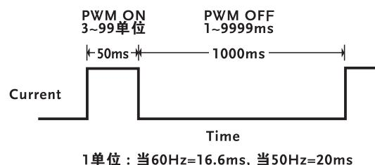
GOM-805 还提供了数种电流输出的驱动模式，以期符合更多样且正确的低电阻测量状况。例如不同材料的导体互相接触时，因各别导体对温度变化不同所产生的热电势，可用脉冲电流输出模式，来降低在低阻测量时的热电动势影响。或材料本身对温度变化相对敏感者，则可使用脉宽调制输出模式，减少因长时间大电流加载造成的阻值变化；直流 +/ 直流 - 电流输出模式，则适用于电感性组件的测量需求。
