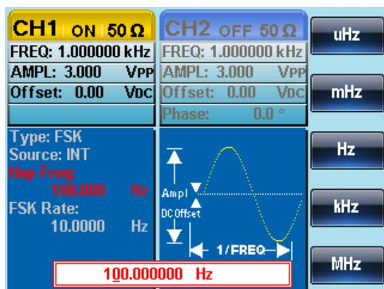
5. 使用方向键和可调旋钮或数字键盘输入跳跃频率
