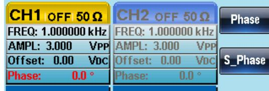
4. 使用方向键和可调旋钮或数字键盘输入输出相位
