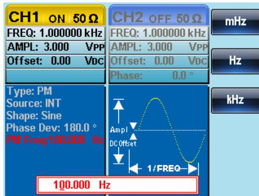
5. 使用方向键和可调旋钮或数字键盘输入 PM 频率
