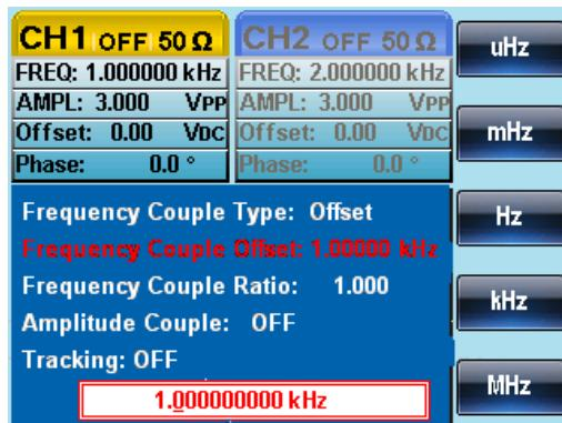
5. 将频率耦合模式改成 Ratio。设置 Ratio 等于 2
