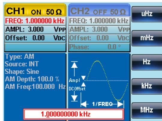
3. 使用方向键和可调旋钮或数字键盘输入载波频率
