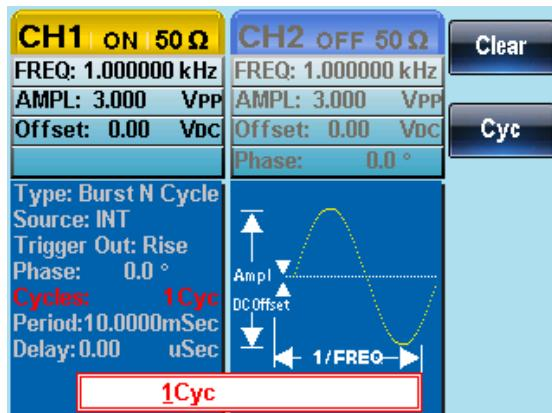
5. 使用方向键和可调旋钮或数字键盘输入循环次数
