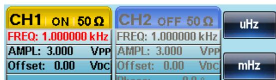
3. 使用方向键和可调旋钮或数字键盘输入频率
