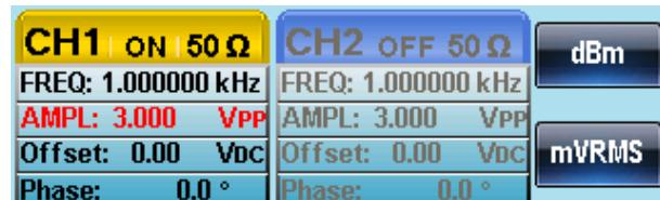
3. 使用方向键和可调旋钮或数字键盘输入幅值
