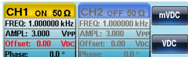
3. 使用方向键和可调旋钮或数字键盘输入 DC 偏移
