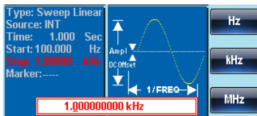
4. 使用方向键和可调旋钮或数字键盘输入 Stop/Start 频率
