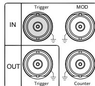
外部触发输入。用于接收外部触发信号
