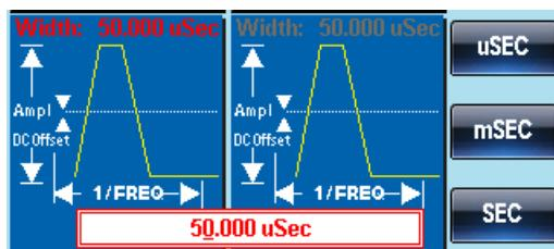
4. 使用方向键和可调旋钮或数字键盘输入脉冲宽度
