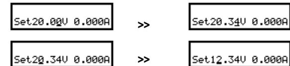
注: 此时 OUTPUT 若为 ON 时，其输出电压会立即的随着旋钮的变动而输出相对应的电压值。
