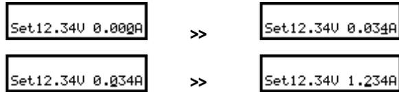
注: 1. 当输出端流过的负载电流，若超过电流设定值时，仪器操作在定电流模式(C.C. Mode)，反之，若未超过电流设定值，则仪器操作在定电压模式(C.V. Mode)。
