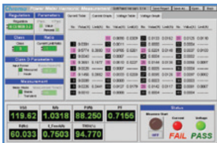
IEC 61000-3-2测试 (法规前测)
