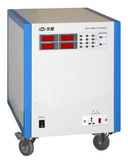
**81000S K/TK系列变频电源是一款**功率 3KVA~60KVA,0-300V 45-65Hz,可订制 0-500V 输出的交流电源,7 个记忆组,可快速 调用输出不同记忆值,有单进单出,三进单出两种电压输入,广泛用于电子电器产品测试。
