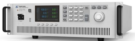
PSA/PWR 系列不仅是可编程交流、直流或交流 + 直流电源，而且集成电压波动与谐波合成功能，模拟正常或异常供电工况，测试验证家电、信息与通信技术、航空、新能源等领域的电子产品的性能及功能。同时集成高精度功率计，可实现高达 99 次谐波成分分析与实时电气参数测量；配备 GUI 监控软件，可对交流电源进行实时监控，并提供多元的简捷操作体验。高性能可编程交流电源集成完善的保护功能（OVP/OCP/OPP/OTP 等），可轻松应对研发、认证、生产检验等阶段的复杂测试。
