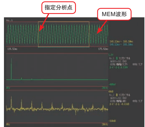
同时显示运算源(MEMORY波形)和FFT运算结果
