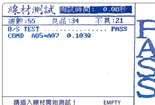
連接器採用四線試量測，導通阻值更為精準，8761 及 8751 線材測試儀導通阻抗值顯示到小數點第三位。
