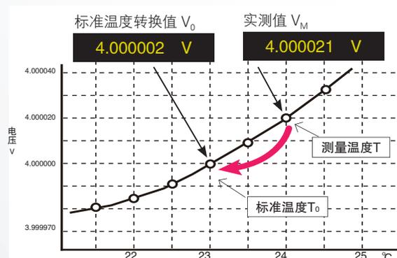
温度补偿运算公式  $V_0 = V_M / (1 + \alpha (T - T_0))$
