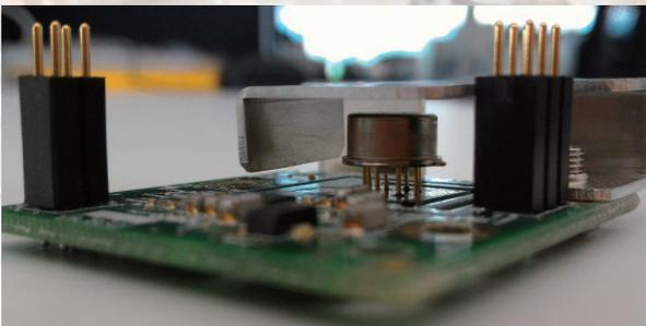
核心部分的基准电压源是通过本公司特别检查的产品，组装之前进行过长时间的评估。更与HIOKI独有的全自动校准“Self-Calibration”搭配，保证1年内9ppm(DM7276)高精度。
