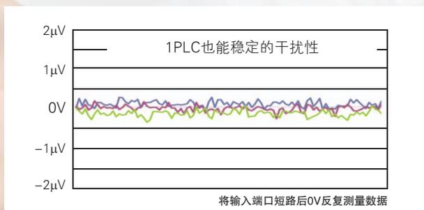
通过将对于温度变化敏感的零部件影响降到最低的电路设计以及Self-Calibration来提供稳定测量。
