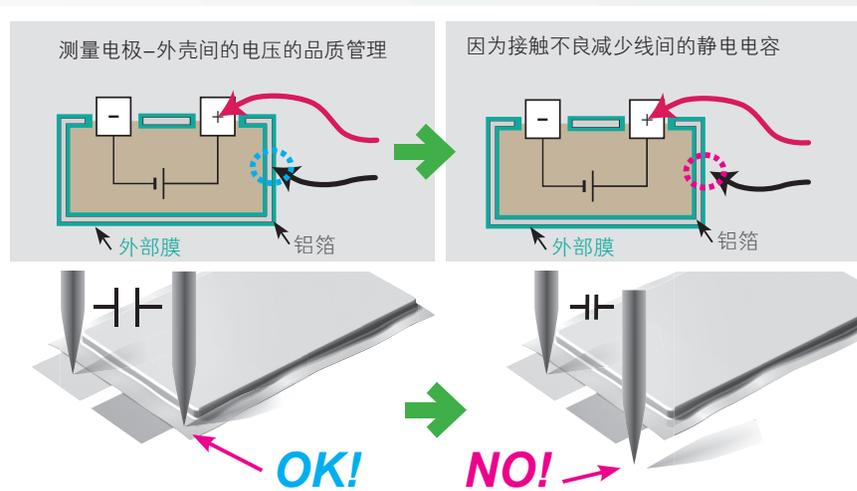
锂电池的外部膜的绝缘不良检查中外壳电位测量有效。锂电池被模制外的测量中，除了精度以外探头接触的可靠性也非常重要。DM系列通过不给测量对象带来压力的10mVrms的微小信号来测量探头之间的静电电容并确认接触情况。用于阈值设置中搭载了电容监视器，可以确认测量值的同时进行设置。
