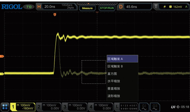
通过触摸手势在闪现的异常信号部分绘制一个矩形框，选择区域触发 A
