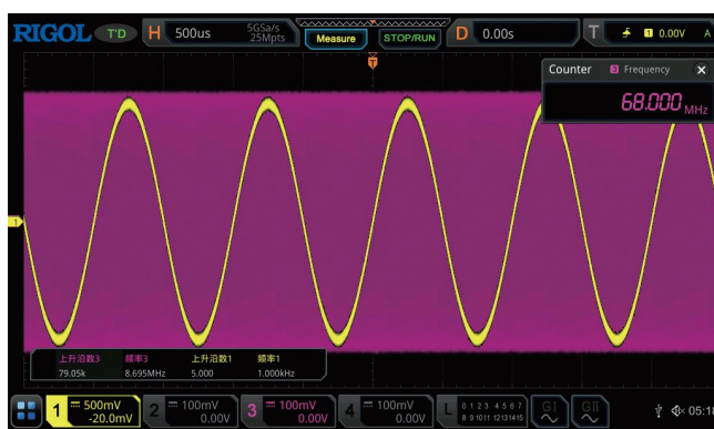
普通 1M 点的软件测量已无法测出高频信号的准确频率
