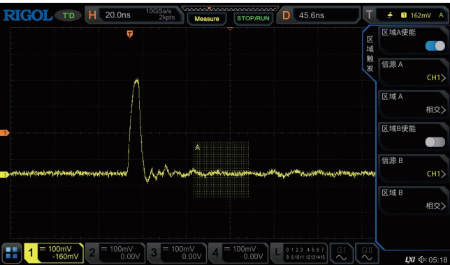
通过边沿触发 + 区域触发，简单快速的分离异常信号
