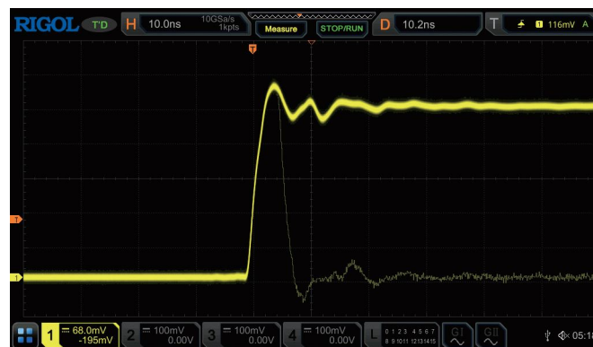
高刷新率模式下捕获偶发异常信号
