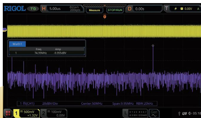
利用近场探头，可以很容易地观察到当探头靠近辐射泄露点时在频域上出现的频谱尖峰
