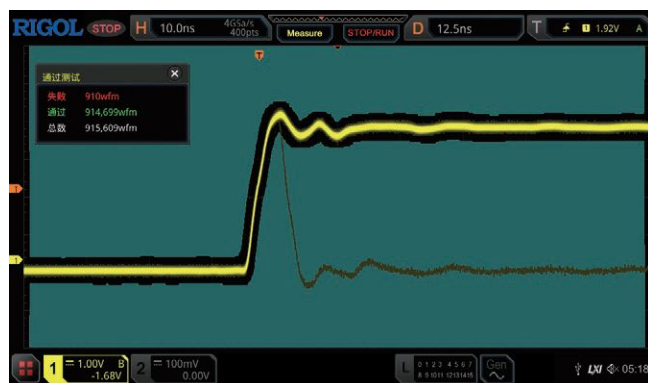
Pass/Fail 测试功能可以快速统计信号中异常发生的概率
