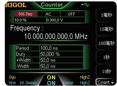
标配 7 digits/s, 200MHz 带宽的频率计
