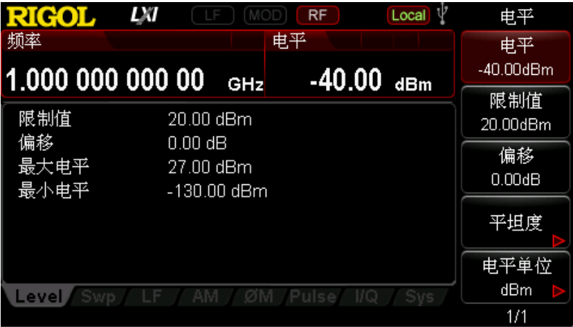
图 4-1 输出 RF 信号参数设置界面
