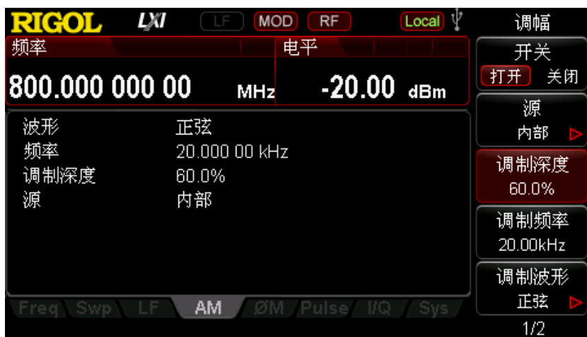
图 4-3 输出 RF 已调信号参数设置界面
