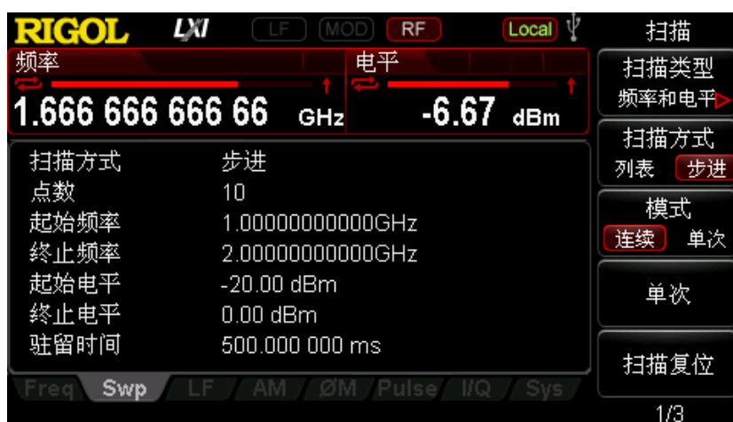
图 4-2 输出 RF 扫描信号参数设置界面
