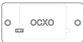
OCXO 为恒温晶体振荡器 (Oven Controlled Crystal Oscillator), 可提供更高温度稳定度的频率参考源。
