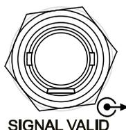
修改 RF 输出频率或幅度时，仪器内部电路经过一定的响应和处理时间后，前面板 RF 输出连接器以指定的频率和幅度输出 RF 信号。在此过程中，[**SIGNAL VALID**] 连接器输出一个脉冲同步信号指示 RF 输出信号的有效性：
