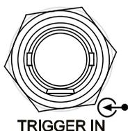
当 **SWEEP** 的触发方式为“外触发”时，该连接器用于输入外部触发信号。您可按 **触发沿** 软键选择“上升沿”或“下降沿”设置该触发信号的极性。当脉冲调制源为“内部”且触发方式为“外部触发”时，用于输入外部触发信号。当脉冲调制源为“内部”且触发方式为“外部门控”时，用于输入外部门控信号。
