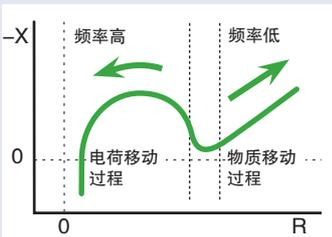
离子的运动等测量必须要用低频，IM3590可测量1mHz。上限频率是200kHz，能够测量溶液电阻。
