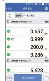
通过测试仪的HOLD件或APP的(保存测量值)将数据保存至设备终端。多个通道的测量也能保存。
