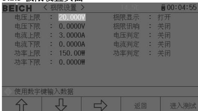
该页面下可以设置电压，电流，功率判断参数，并在主测试界面显示区域内显示判断结果，超过设置值的会以红色反显提示。
