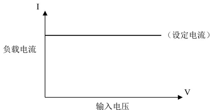
按【定电流】键进入定电流模式，该按键灯亮起，通过数字按键输入需要设定的电流值，输入的数字会在状态栏
