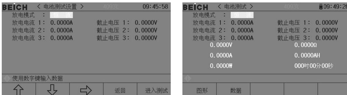
放电测试可以以定电流或定电阻方式工作，以测定电池类电源的放电时间及容量；持续放电过程中，电池电压不断跌落，当负载输入电压低于设定值时，放电测试自动停止，仪器可显示放电时间及电池容量。仪器最多可以设置三档放电电流及截止电压，以能更好的模拟实际电池在不同电流应用下的状态，放电电流 1 在达到条件后会自动转为 2 直至 3，所以在设置截止电压时也要按电压下降梯度，截止电压 3 不能高于 2 不能高于 1。
