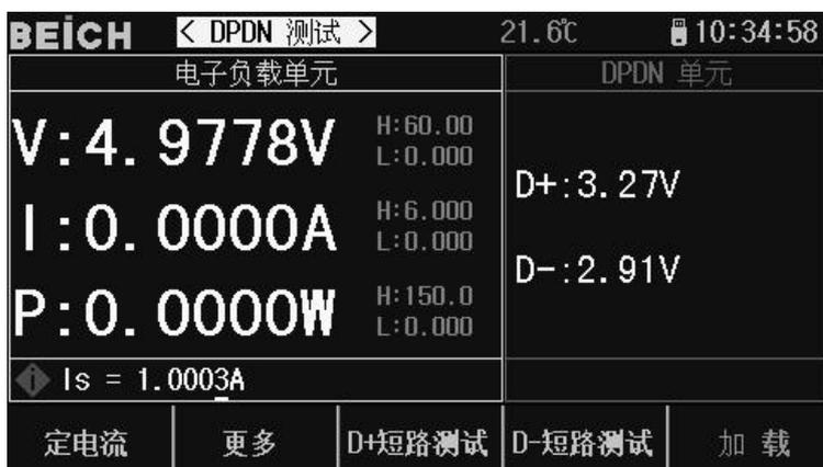
该页面下可以同步测试普通充电器 D+D-电压，并可由机器输入 3.3V 电压供测试，以测试对地是否短路，按对应按键选择 D+短路测试或 D-短路测试，在列表中可以将 D+D-电压一并作为判断条件进行判断。
