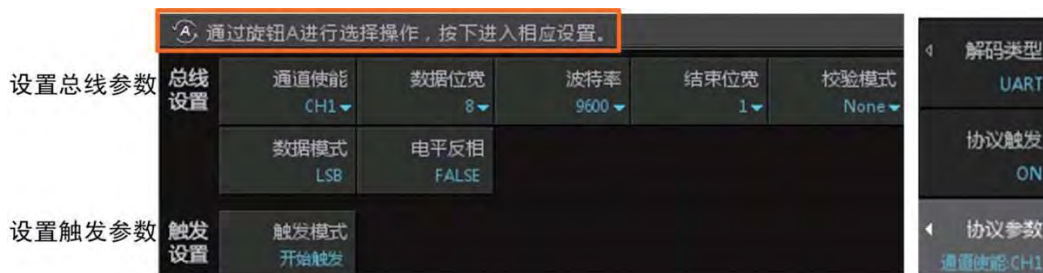
图 15.12 设置协议参数
