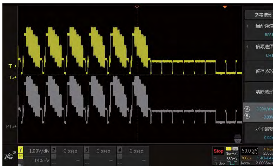
图 21.12 参考波形垂直方向调节
