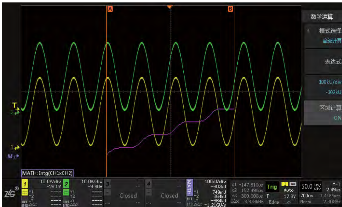
图 18.11 能量损耗的区域运算结果
