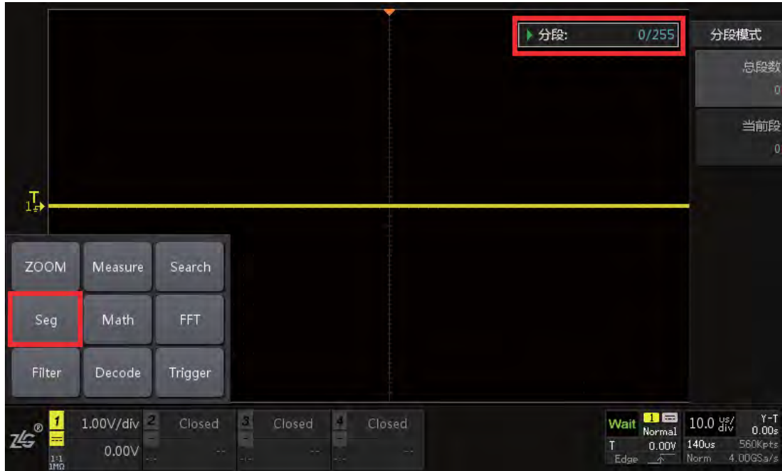
图 20.2 分段存储设置
