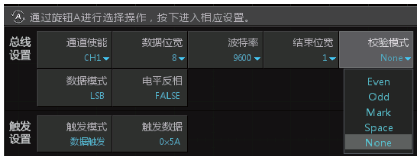
图 15.34 解码协议参数
