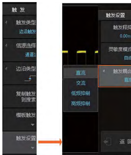
图 10.22 触发耦合设置
