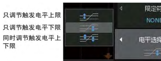
图 10.37 触发电平上限、触发电平下限的调节方式
