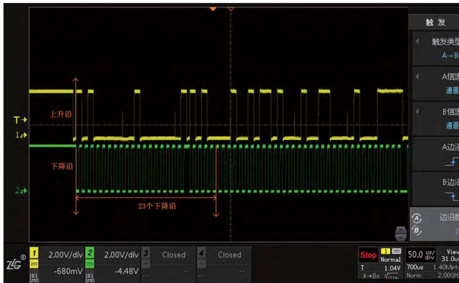
图 10.53 A->B 触发效果图
