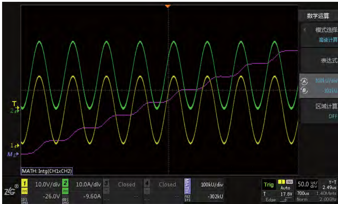
图 18.9 能量损耗运算结果
