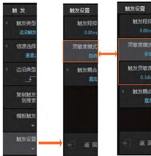
图 10.20 触发灵敏度设置
