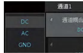
图 9.2 通道耦合设置示例
