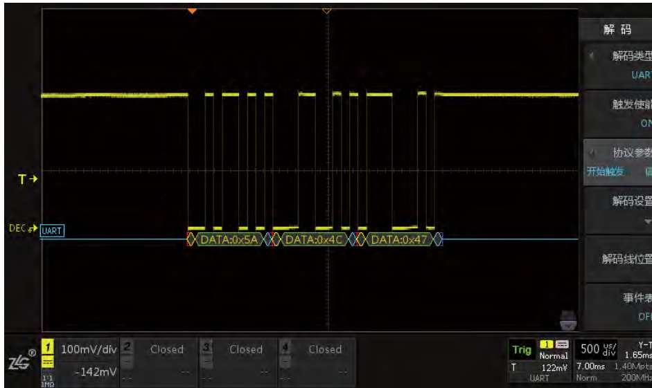
图 15.36 ZDS3000/4000 系列示波器的 UART 信号
