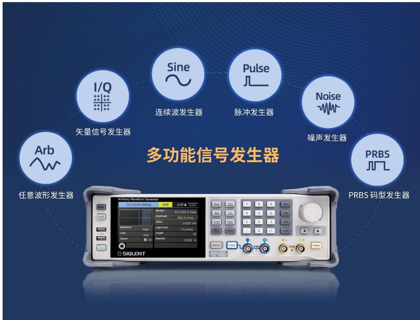
SDG7000A 是一款集多种信号发生器功能于一体的产品。它可以产生直流到 1GHz 范围的连续波，在一定场合下取代射频信号源；采用了鼎阳的 TrueArb 逐点任意波形发生技术，可以在 0.01 Sa/s ~ 2.5 GSa/s 的范围里任意设置采样率，输出低抖动的任意波；可以产生 I/Q 矢量信号，最大可设置的带宽超过 500 MHz；基于 EasyPulse 脉冲发生技术，可以产生脉宽最小只有 1 ns 的低抖动脉冲；可以产生带宽可调的高斯噪声；可以产生伪随机码；另外提供 16 路数字信号输出
