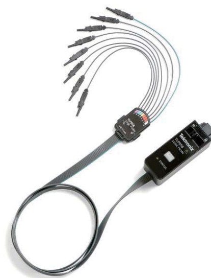
TLP058 提供了 8 个高性能数字输入。根据需要连接多只 TLP058 探头, 支持最多 48 条数字通道。
