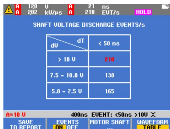
电机轴电压放电事件数量
