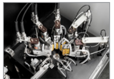
5组层间测试站
