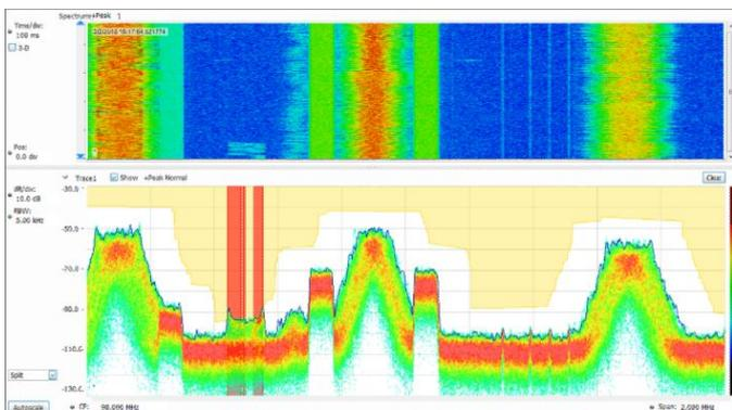
标配 SignalVu-PC 软件可以迅速简便地完成寻向和信号强度测量。在下图中，通过使用选配的 Alaris 智能天线，罗盘持续监测天线方向，同时信号强度监测仪执行测量，用声音表明信号强度。在与 SignalVu-PC 的 MAP 选项结合使用时，信号强度和方位角自动放在选择的地图上。
