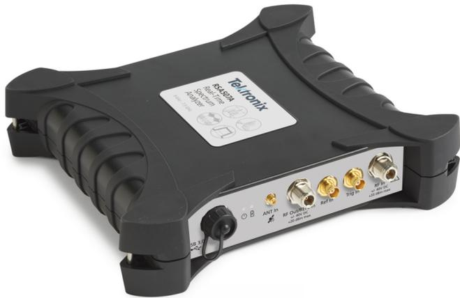
RSA500A 系列 USB 频谱分析仪在坚固耐用、电池供电的仪器中提供了高性能便携式频谱分析功能。
