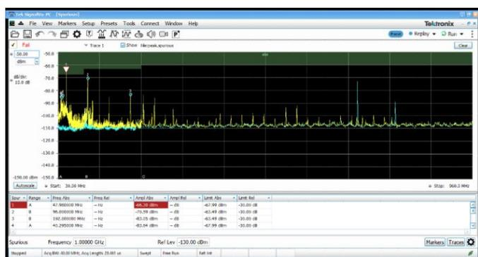
蓝牙 – 增加了两个新选项，帮助您在时域、频域和调制域中进行基于 Bluetooth SIG 标准的发射机 RF 测量。选件 SV27 支持 RF 规定的基本速率和低功耗发射机测量。TS.4.2.0 和 RF-PHY。TS.4.2.0 测试规范。它还解调并提供增强数据包的数据符号信息。选件 SV31 支持蓝牙 5 标准 (LE 1M、LE 2M、已编码 LE) 和核心规范中规定的测量。这两个选件也解码所传输的物理层数据并使用颜色编码符号表中的数据包字段以便清晰标识。
