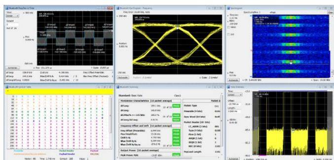
提供了测试通过/失败结果，支持量身定制的极限。下面的测量显示了方差相对于时间关系、频率偏置和漂移、测量摘要及测试通过/失败结果。
