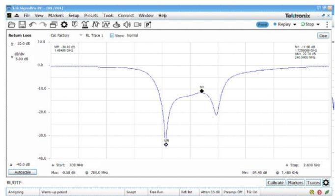
从 700 MHz ~ 2.6 GHz 测得的通带滤波器的回波损耗。标记被放在 1.48 GHz (-34.4 dB 回波损耗)和 1.73 GHz (-11.68 dB 回波损耗)处，指明滤波器通带中的最佳匹配和最差匹配。
