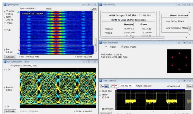
LTE – 应用 SV28 实现了下述 LTE 基站发射机测量：
