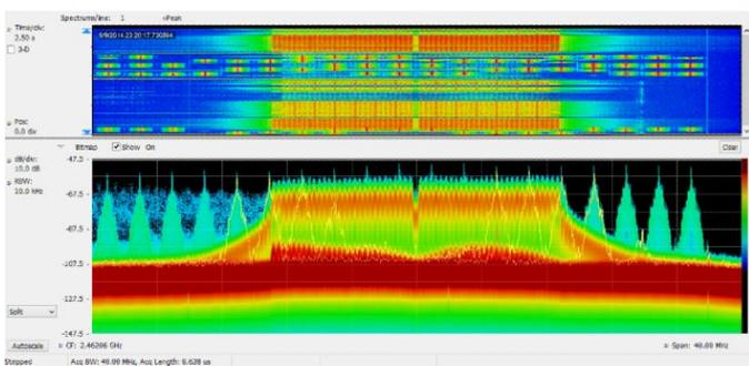
通过无人值守的模板监测功能，可以方便地找到意外的信号。可以在 DPX® 频谱画面上创建一个模板，在每次违规时采取相应操作，其中包括停止采集、保存图片、保存采集或发送声音告警。在下图中，模板中红色位置发生了模板违规，因此将保存屏幕图片。模板测试可以用于无人值守监测，在播放记录的信号时，可以在相同信号上测试不同的违规。
