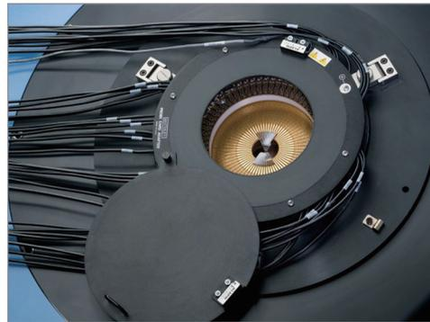
图 5: 探针台上安装 9139B-PCA 探针卡接口
