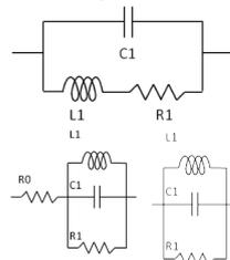
6223/6243DC 偏流磁飽和測試系統所搭載的 6632 阻抗分析儀結合多種元件組態建構等效電路模型，分析不同頻段下寄生元件影響整體阻抗變化，可透過修改元件參數進行實測待測物與公式模擬計算出的曲線進行比對，是分析 SRF 最佳工具。
