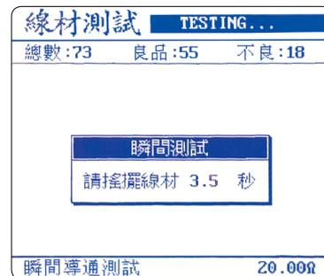
線材測試儀系列「瞬間斷短路」功能即搖擺測試，可設定測定時間的秒數，線材測試儀器會在設定的時間內不停的掃描，進行短斷路判斷測試，此時需實際搖擺活動待測物，若在時間內有跟原先短斷路表有出入的點位時，就會判斷是 NG 品。瞬間斷短路不良的原因大致是接點冷焊，端子與接點箱夾太鬆，接點芯絲即將全斷，芯絲外露與相鄰臨接點太近等情況。
