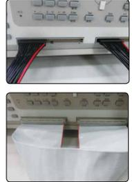
兩個點一條線就稱之為一個迴路 (Net)，要測量線材，必須先形成一個迴路再量測。當線材兩端都插上機器或藉由治具產生迴路時。按下學習，機器螢幕右上方就會自動顯示 Nets/ Pin 值。圖右上範例 26 條線 (Pin)/ 迴路 (Net)，56 個點 (Pin)。圖右下範例 64 條線 (Pin)/ 迴路 (Net)，128 個點 (Pin)。
