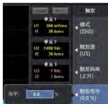
图 8.17 设定触发电平
