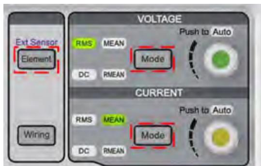
图 6.2 选择电压模式、电流模式
