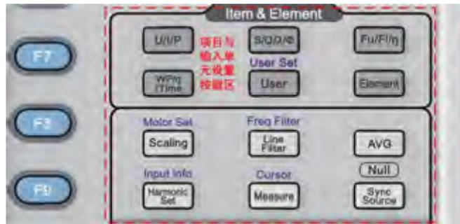
图 5.24 显示项目与输入单元设置按键区
