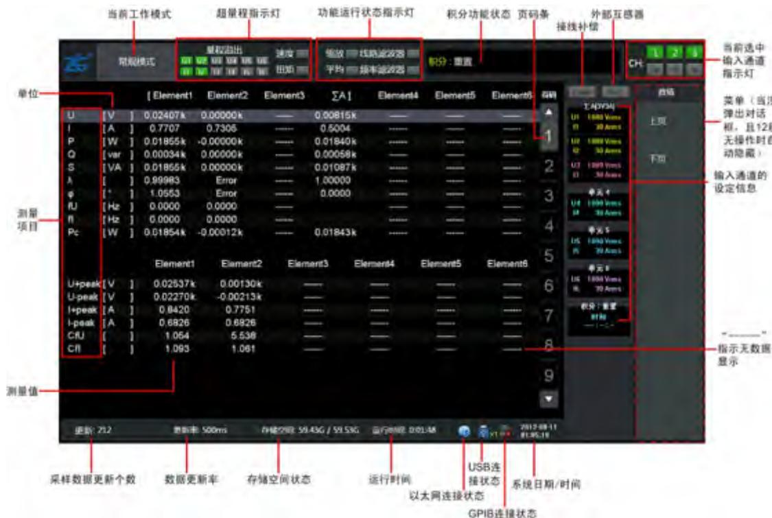
图 5.2 常规测量模式下的屏幕显示
