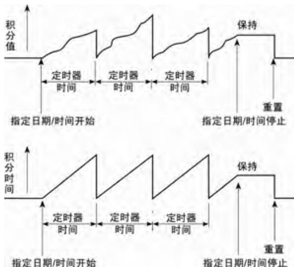
图 14.14 实时循环积分模式示意
