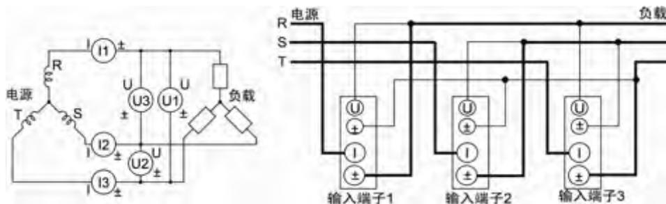
图 6.55 三相 3 线制 (3 电压 3 电流表法), 测量仪表接线
