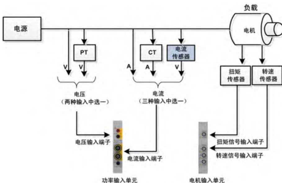
图 4.23 输入信号到输入单元
