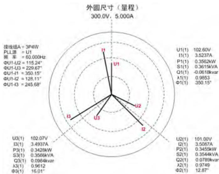
图 16.1 三相四线制接线组向量显示示例
