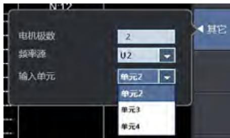
图 19.16 选择用于测量电机的输入单元
