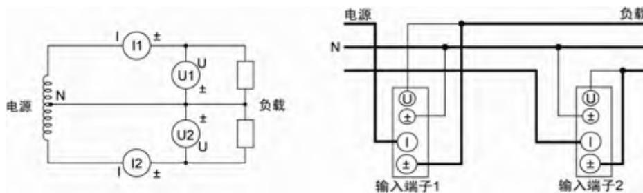
图 6.49 单相 3 线制(1P3W)，测量仪表的接线
