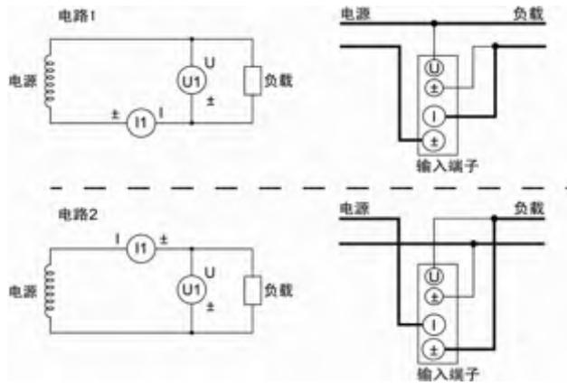
图 6.46 单相 2 线制(1P2W)，测量仪表的接线
