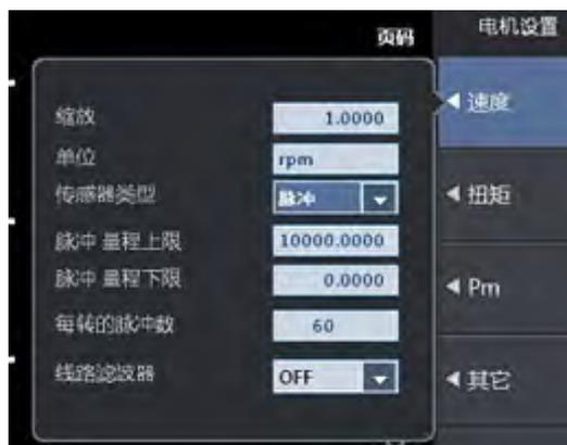
图 19.7 脉冲输入量程
