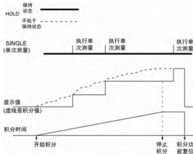
图 14.16 按下单次测量键后的积分显示
