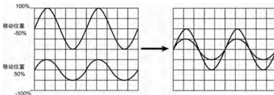
图 8.19 波形垂直移动示例
