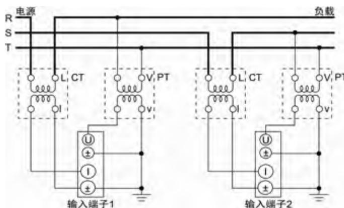
图 6.53 三相 3 线制(3P3W)、使用 PT/CT 时的接线举例
