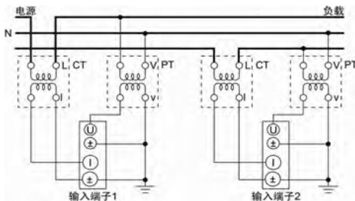
图 6.50 单相 3 线制(1P3W)、使用 PT/CT 时的接线举例
