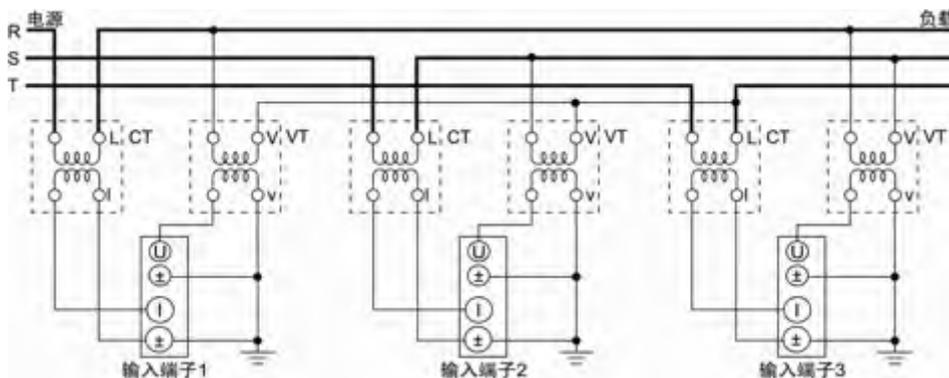
图 6.56 三相 3 线制 (3 电压 3 电流表法), 使用 PT/CT 的接线
