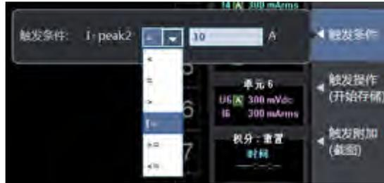
图 20.33 常规数据触发类型下的触发条件
