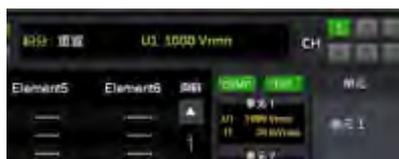
图 6.24 电压量程显示
