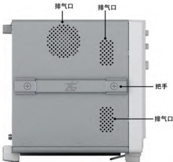
图 5.28 左侧面板示意图
