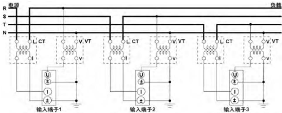
图 6.59 三相 4 线制(3P4W)、使用 PT/CT 时的接线举例
