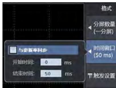
图 8.8 设定时间轴长度
