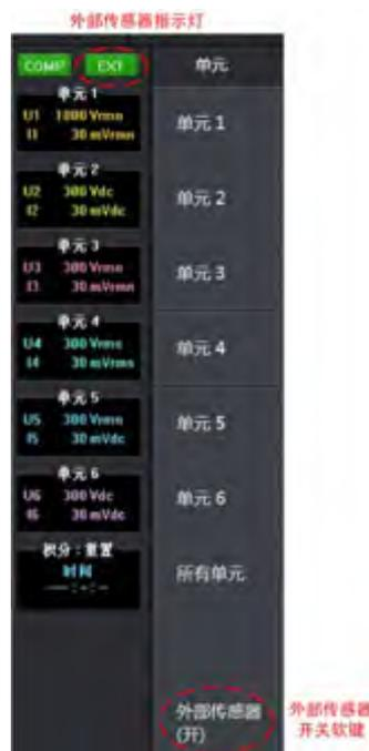
图 6.25 外部传感器的开启/关闭
