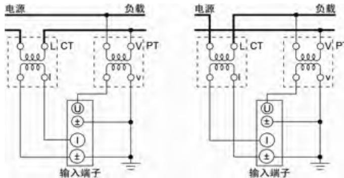
图 6.47 单相 2 线制(1P2W)，使用 PT/CT 时的接线举例
