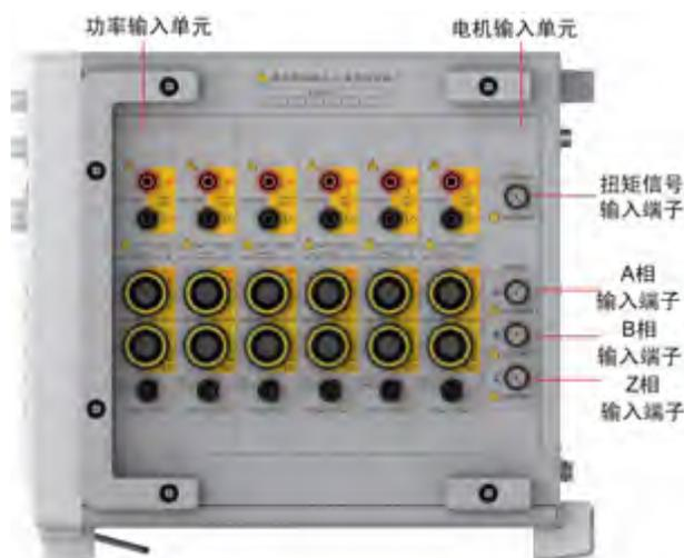
图 4.22 电机信号输入
