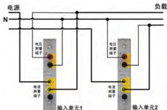
图 6.51 1P3W 下功率分析仪接线实例
