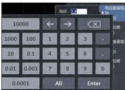
图 8.23 电压垂直缩放
