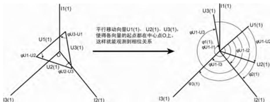
图 16.5 3P3W (3V3A) 向量显示示例
