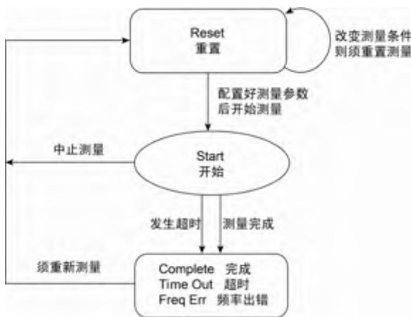
图 13.3 周期分析测量状态转换图
