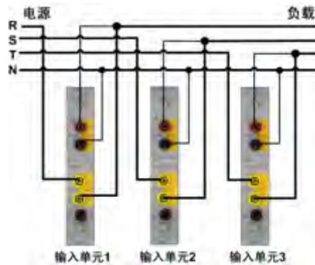
图 6.60 三相 4 线制接线实例
