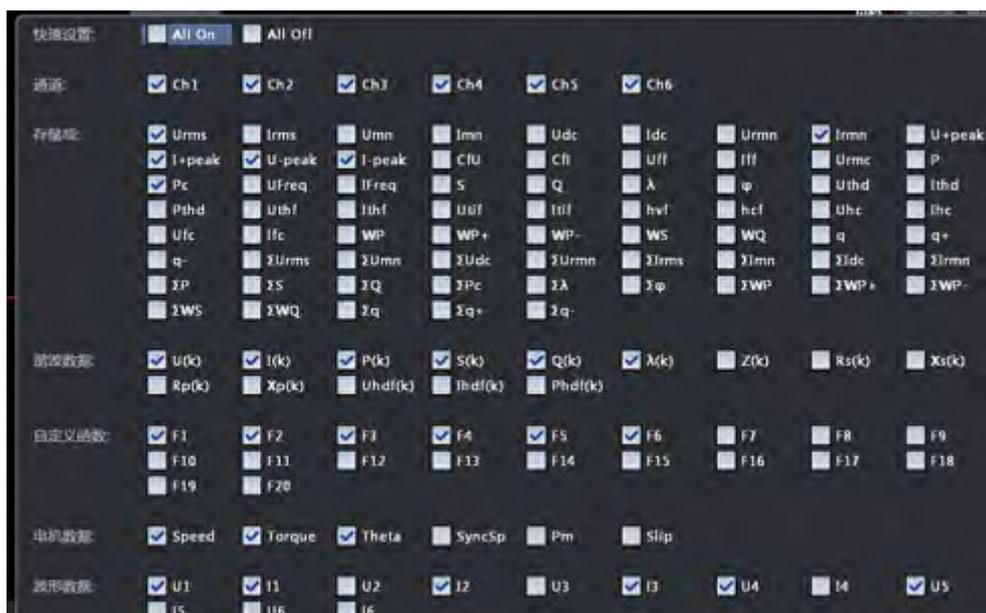
图 20.39 选择要储存的数值数据和波形显示数据
