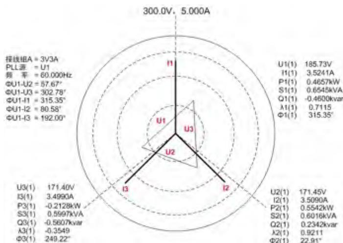
图 16.4 3P3W (3V3A) 向量显示示例
