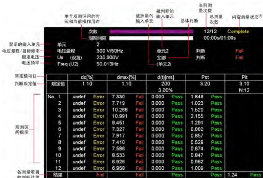
闪变测量状态包括：Reset (重置测量值，初始化)、Initializing (正在初始化)、Ready (初始化完毕，就绪，可开始测量)、Start (正在测量，右侧显示测量时间)、Complete (完成)。
