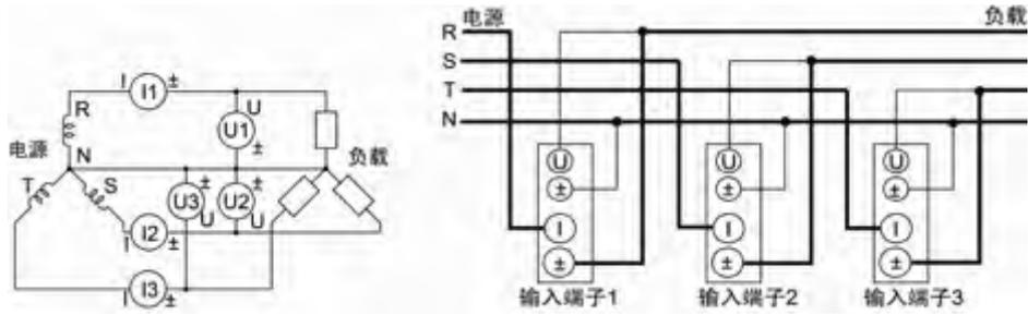
图 6.58 三相 4 线制下的测量仪表接线
