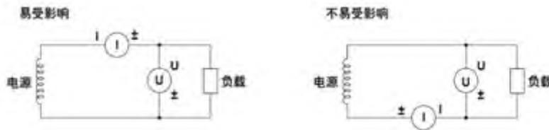
图 6.44 降低杂散电容对测量精度的影响
