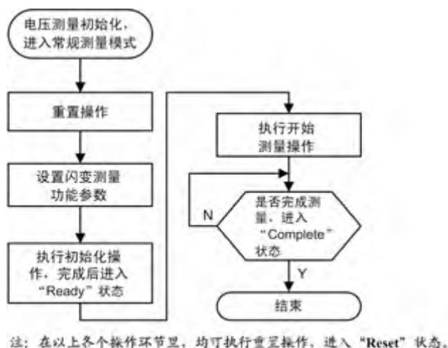
图 18.9 常规闪变测量操作
