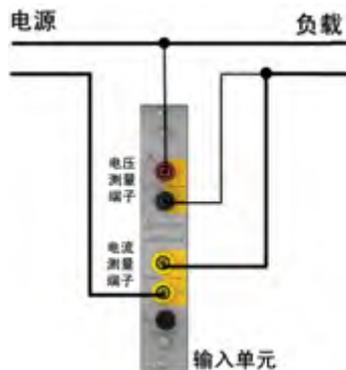
图 6.48 1P2W 下功率分析仪接线实例
