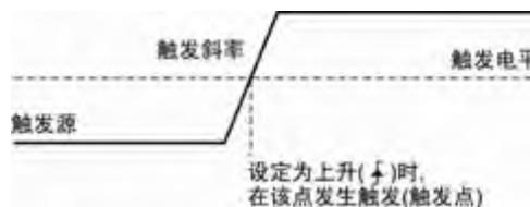
图 8.11 触发参数示意
