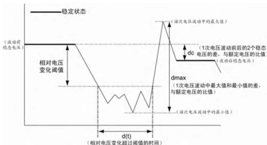
图 18.27 dc、 $d_{max}$ 、 $d(t)$ 之间的关系
