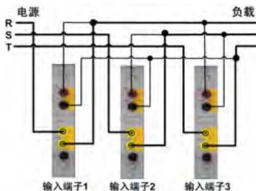
图 6.57 3P3W (3 电压 3 电流表法) 下功率分析仪接线示例
