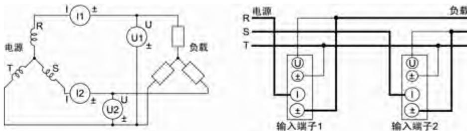
图 6.52 三相 3 线制、测量仪表的接线
