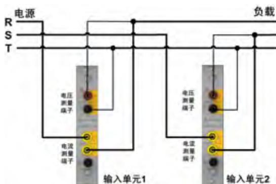
图 6.54 3P3W 下功率分析仪接线示例
