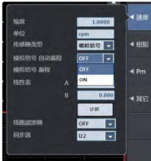
图 19.3 转速传感器信号模拟信号自动量程配置
