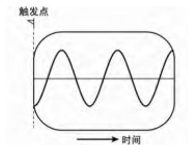
图 8.10 触发点后的波形显示
