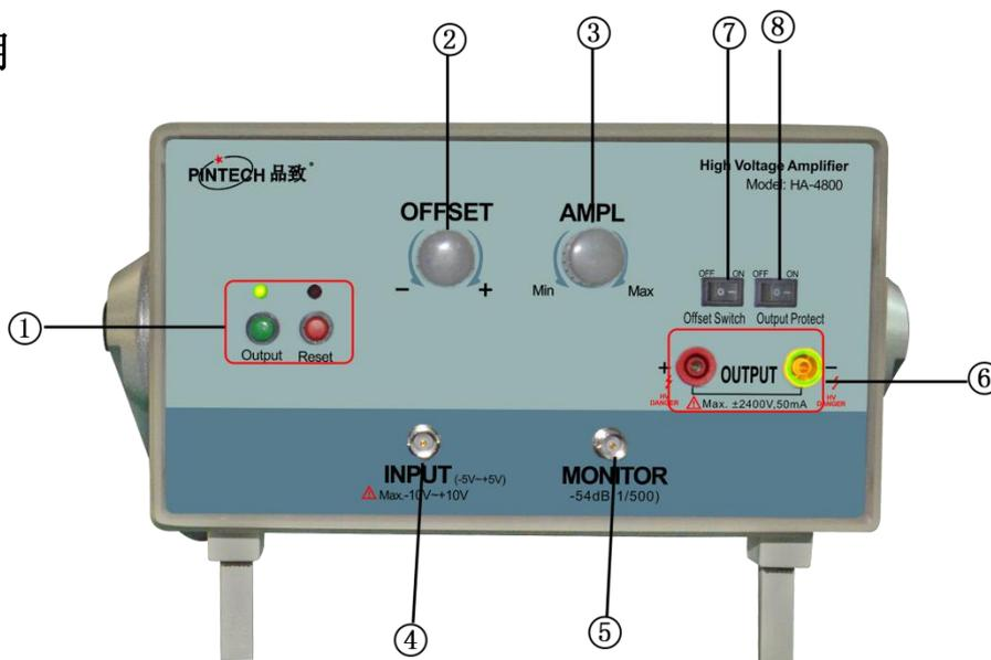
①输出(Output): 按下开关, 绿色灯亮起表示开启输出, 绿灯熄灭表示关断输出。
