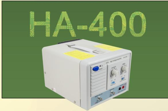
使用函数波产生器当输入时，使用大型10转的可变电阻，能获得更精确的电压，能获得0-90倍的电压增益，使用时必须先将直流抵补偏压(OFFSET Switch)设定在ON的位置。
