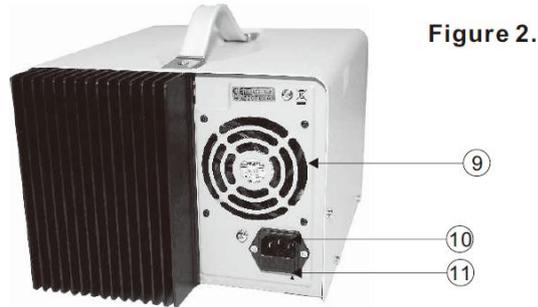
⑨散熱風扇: 吸出型, 使用 24V/DC/0.11A
