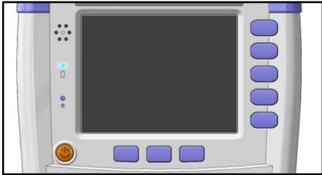
图 3-3 充电指示灯，充电时显示为蓝色
