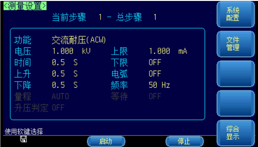
图 4-2 交流耐压测试参数设置页
