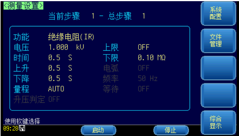
图 4-4 绝缘电阻测试参数设置页
