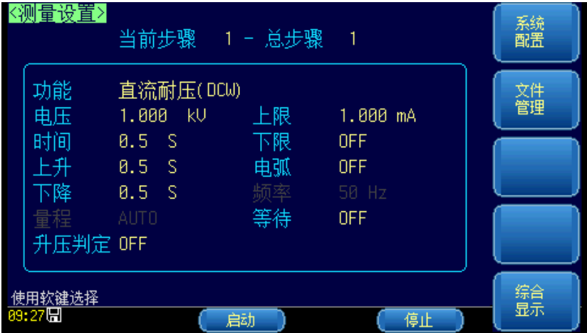
图 4-3 直流耐压测试参数设置页
