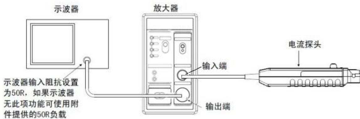
图 19 测试平台搭建示意图
