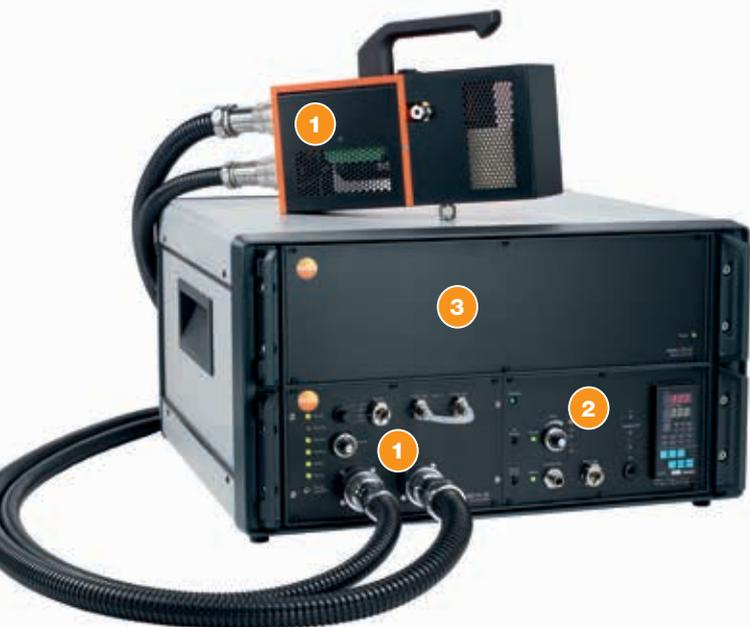
使用德图的旋转盘稀释器 **testo MD19-3E** ①，可以进行热稀释。旋转盘稀释器与空气蒸发管 - **testo ASET15-1** ②，以及数据采集装置 **testo CU-2** ③ 相结合，组成了一整套热稀释系统，即 **testo ViPR** 挥发颗粒取样器 **testo ViPR**。
