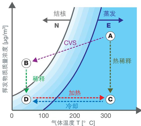
在稀释通道中，物质的浓度和温度都会降低（A → B）。在稀释过程中，物质的状态经过露点，结核成为微露滴（曲线N）。接下去的次级稀释（B → D）会降低露滴颗粒的浓度，但是无法重新蒸发这些露滴，这是因为结核作用与蒸发作用之间的迟滞效果的缘故。
