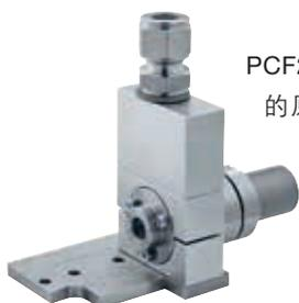
PCF2.5旋风切除器模块专门为从CVS通道中抽出的原始气体中的粗颗粒去除而设计。它坚固耐用，使用方便。通常来讲，它能切除空气动力直径2.5µm以上的颗粒。使用这款设备可以满足UNECE R83 及 R49规定的推荐要求。
