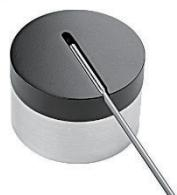
2 将带有探头端的底盘放到待测温度板中的测量点上。
