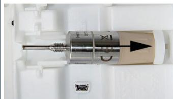
► 当隔离环位于两个通信触点之间时，则说明正确安装固定了数据记录仪。
