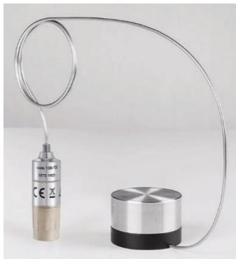
3 弯曲探针，以便冻干探头固定座完全接触层板。
