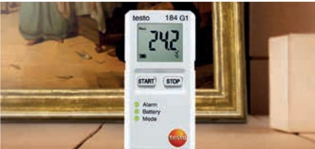
testo 184 G1 数据记录仪，监测振动、湿度和温度，安全而方便地监测敏感产品的运输：
