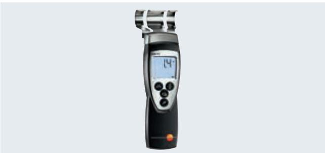
只需简单地选择相应的材料特性曲线，并将感应式探头放置于被测表面，该水分检测仪即以干燥重量的质量比显示被测材料的水分含量。按键即可保持测量读数。
