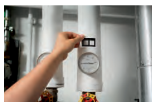
粘贴德图发射率标签
