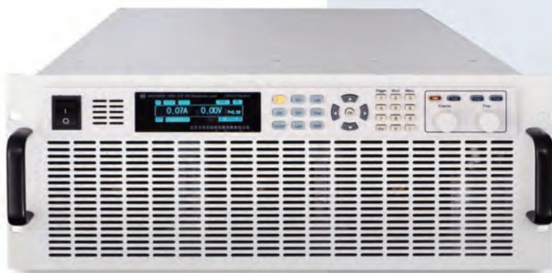
DH27800E 系列大功率可编程直流电子负载，功率密度可达 4U/6kW，可提供 150V、600V、1200V 三种电压等级，满足用户多种测试需求；具有 CC、CV、CP、CR、CC+CV、CR+CC、CP+CC 7 种工作模式，并且具备动态和列表等测试功能。过压、过流、过功率、过温、反接等多种保护功能为用户安全使用提供保障；标配 LAN 和 USB 通信接口，方便用户通过远程控制。
