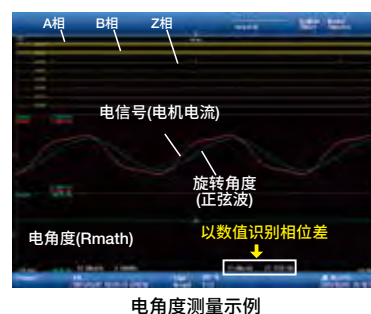
电角度测量示例
