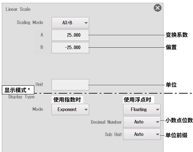
\* 用电压模块测量电压或者应变模块测量应变时设置。
