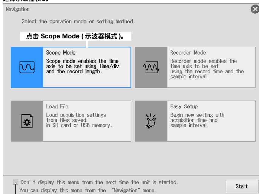
如果选择此确认框, 下次启动仪器时不会出现此菜单而直接进入波形屏幕。点击波形屏幕中的 **MENU > Navigation** 显示此导航画面。
