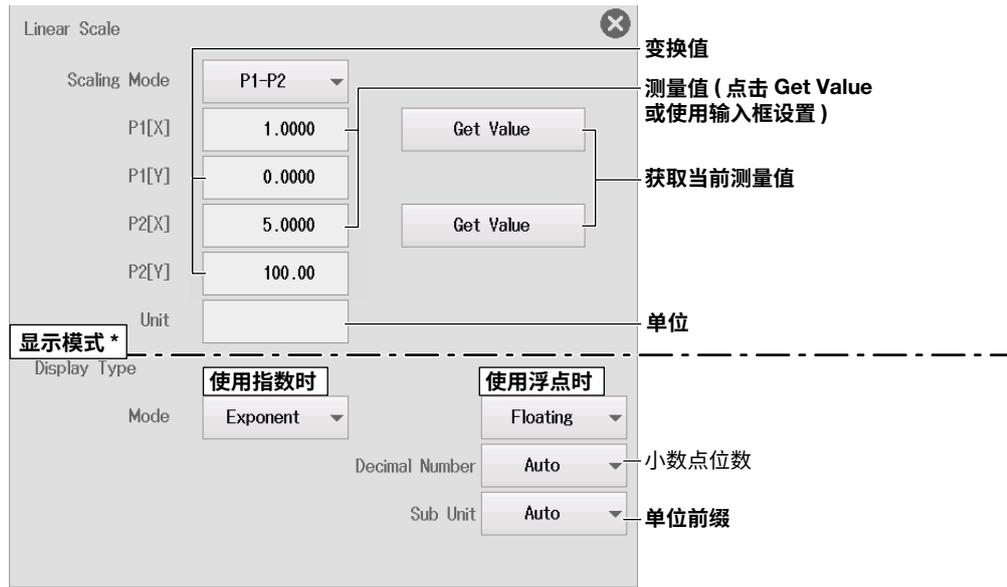
\* 用电压模块测量电压或者应变模块测量应变时设置。
