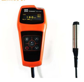
TIME®2510E 覆层测厚仪采用磁性和电涡流两种测厚方法,可无损的测量磁性金属基体上的非磁性覆盖层的厚度(如钢、铁、合金和硬磁性钢上的锌、铝、铬、铜、橡胶、油漆等);及非磁性金属基体上的非导电层的厚度(如铜、铝、锌、锡等金属上的油漆、橡胶、塑料、氧化膜等)TIME®2510E 覆层测厚仪相比我司现有分体式覆层测厚仪,体积更加小巧,并采用了高亮 OLED 屏幕,显示更清晰。
